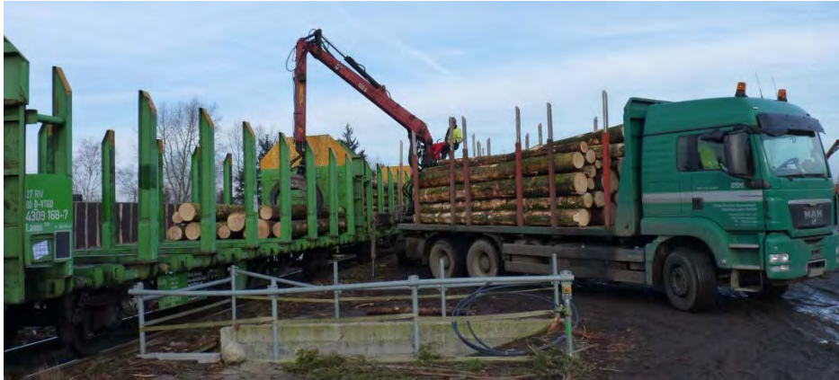
Bild 5 Blick auf einen Lkw mit Ladekran beim Verladen von Baumstämmen auf einen Waggon
