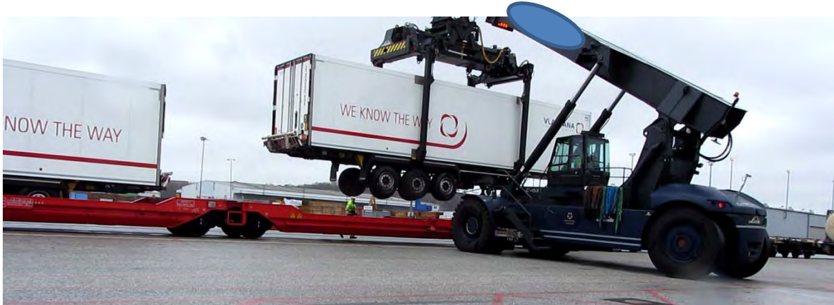
Bild 3 Entladen eines Trailers von einem Waggon mit einem Reach-Stacker
