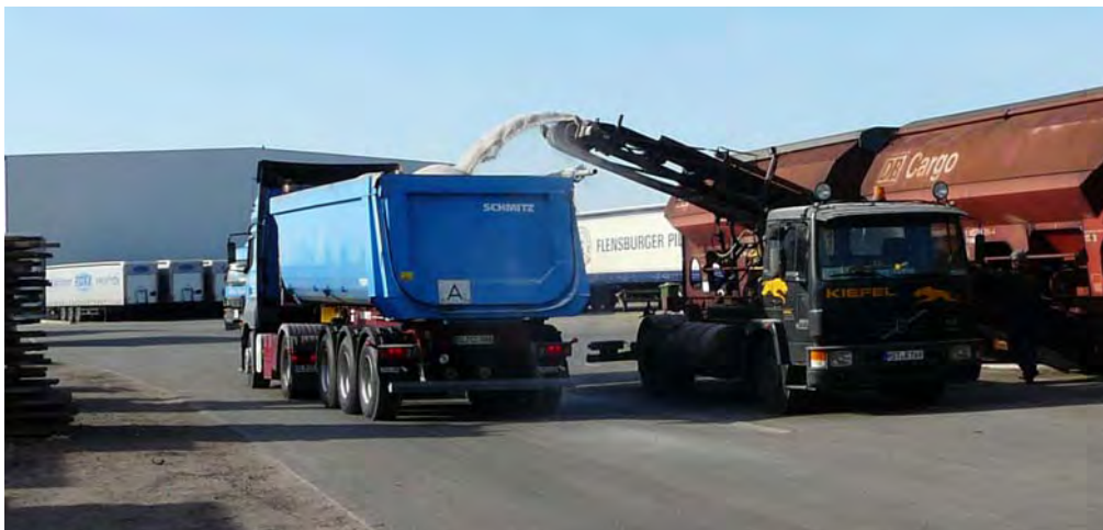
Bild 4 Entladen eines Trichterwagens mit Förderband in einen Lkw
