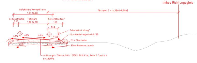
°Die Regelbreite der Seitenstreifen beträgt 0,50m. Von Station 000 bis 200 und von Station 589 bis 828 wird der Seitenstreifen mit einer Breite von 1,5m inkl. Schutzplanke (Aufenthaltsstufe N2/W5) ausgeführt.
