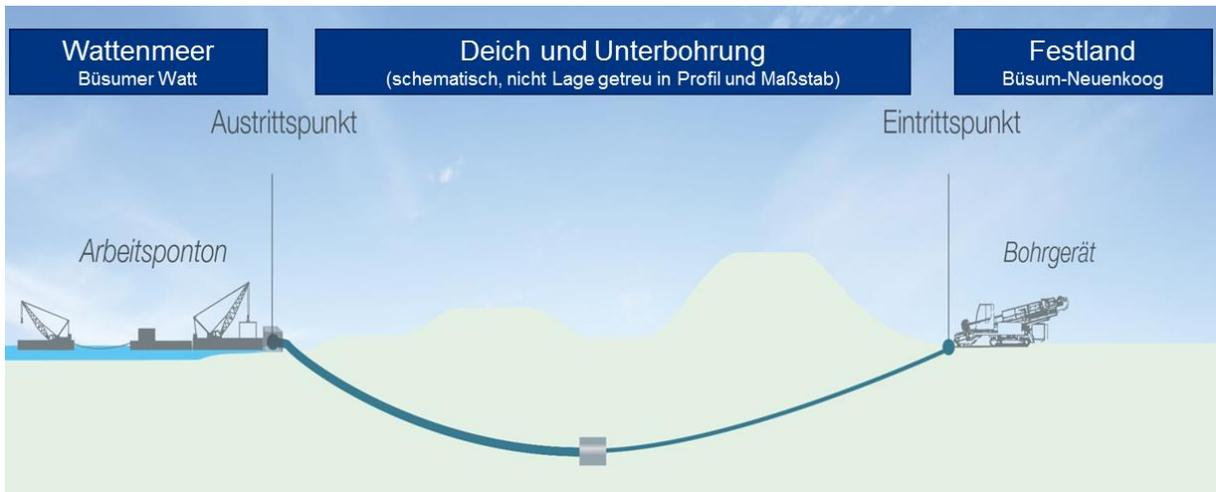
**Abbildung 1: Schematische Anordnung einer HDD Bohrung an einem Deich mit Watt als Vorland.**
