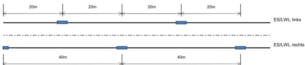
Einbauorte: komplette Leitungsanlage (Abstand von Mast 10-20m), ausgenommen Verdichtungsgebiete (s. Folgedarstellung)
