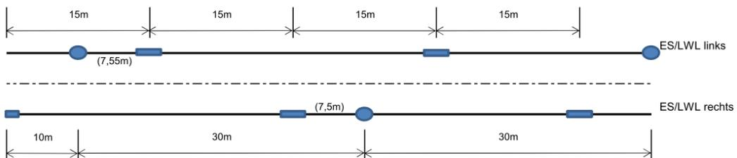
**Einbauorte:** Vogelschutzmarker: Verdichtungsgebiete (Abstand von Mast 10-15m), Mast 29-33, Mast 114-120, Mast 140-145 und Mast 165-169
