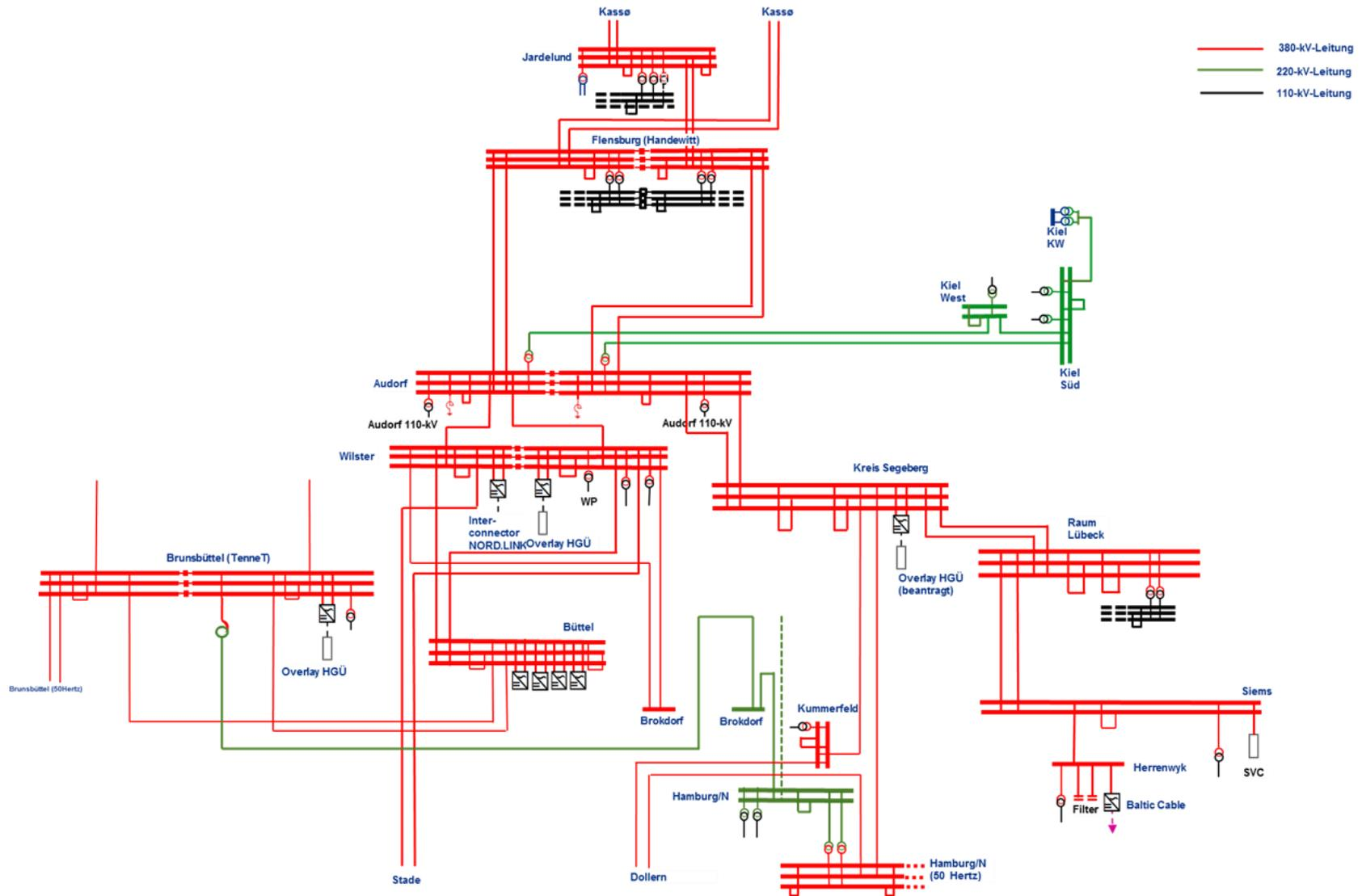
Abbildung 10: Schematische Übersicht über die Netzstruktur nach Realisierung der Vorhaben in Schleswig-Holstein
