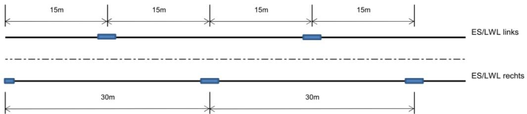
**Einbauorte:** Verdichtungsgebiete (Abstand von Mast 10-15m), Mast 29-33 und Mast 114-120
