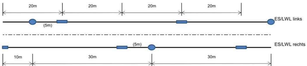
**Einbauorte:** Vogelschutzmarker: Mastfelder 109-110 und 130-172 (130-134 bereits als Vorkehrung für geplante A20), (Abstand vom Mast 25-35m)
