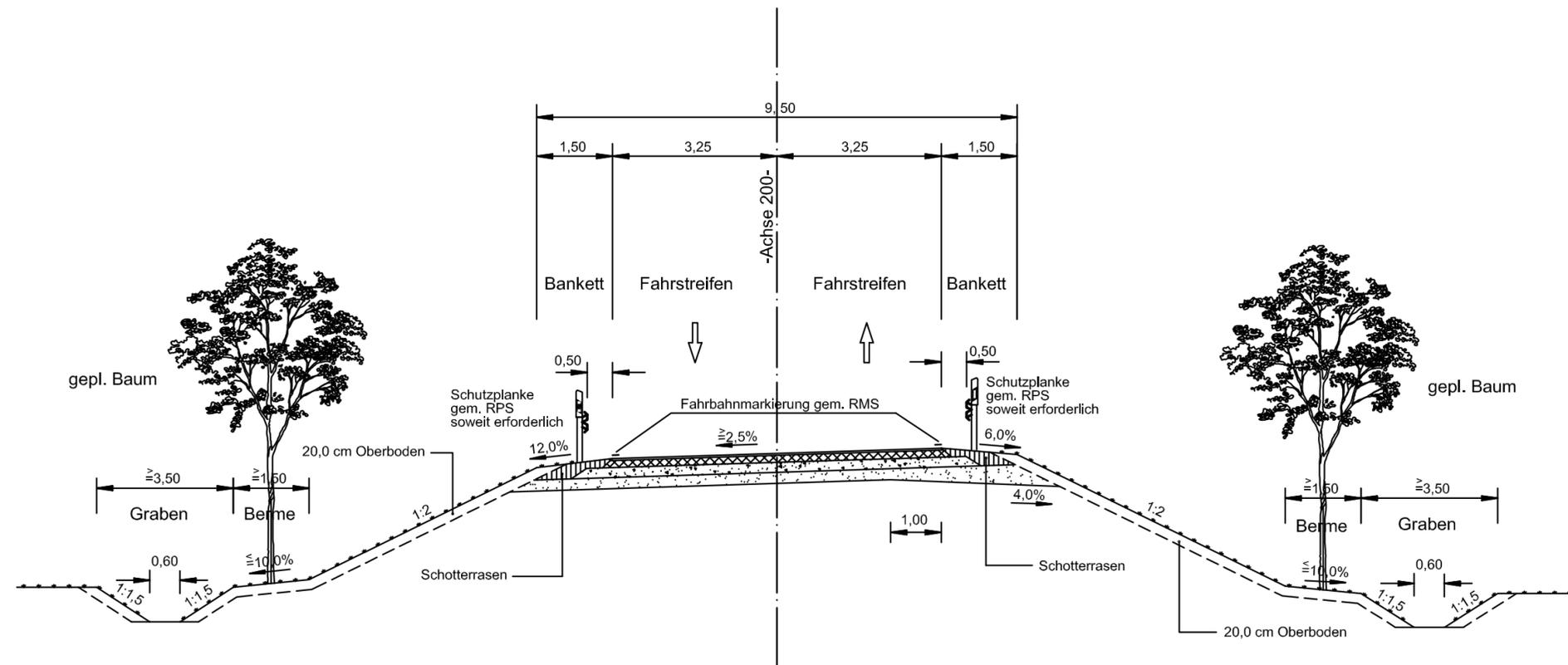
Deckenaufbau Fahrbahn gem RStO 01 Baukl. IV
