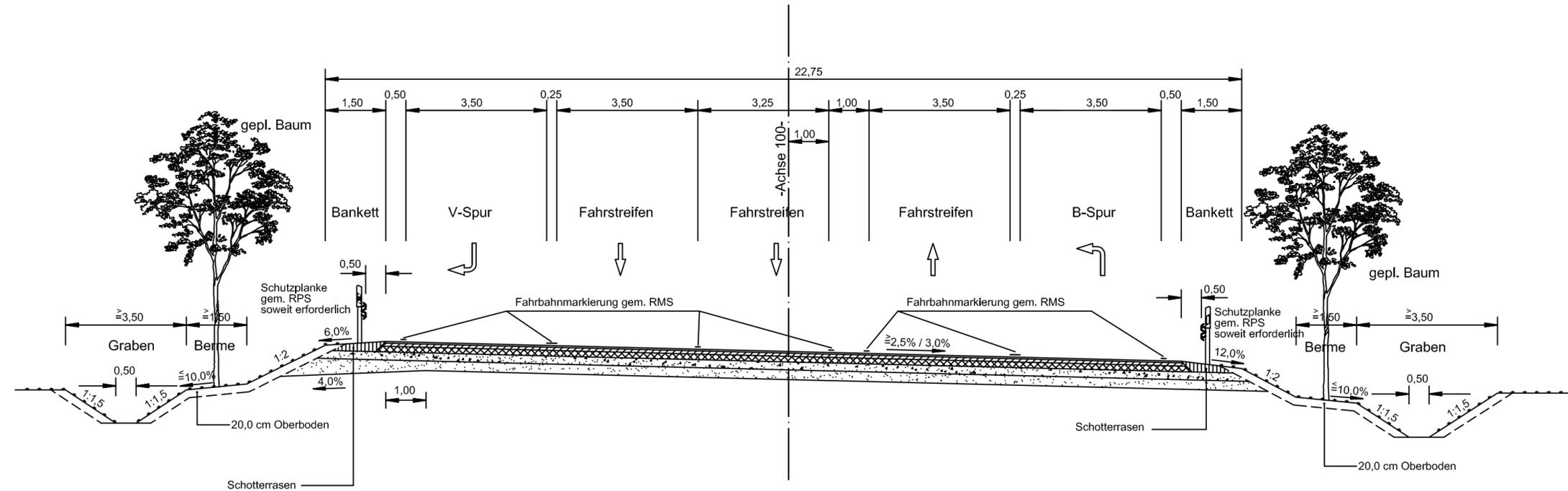
Deckenaufbau Fahrbahn gem RStO 01 Baukl. II
