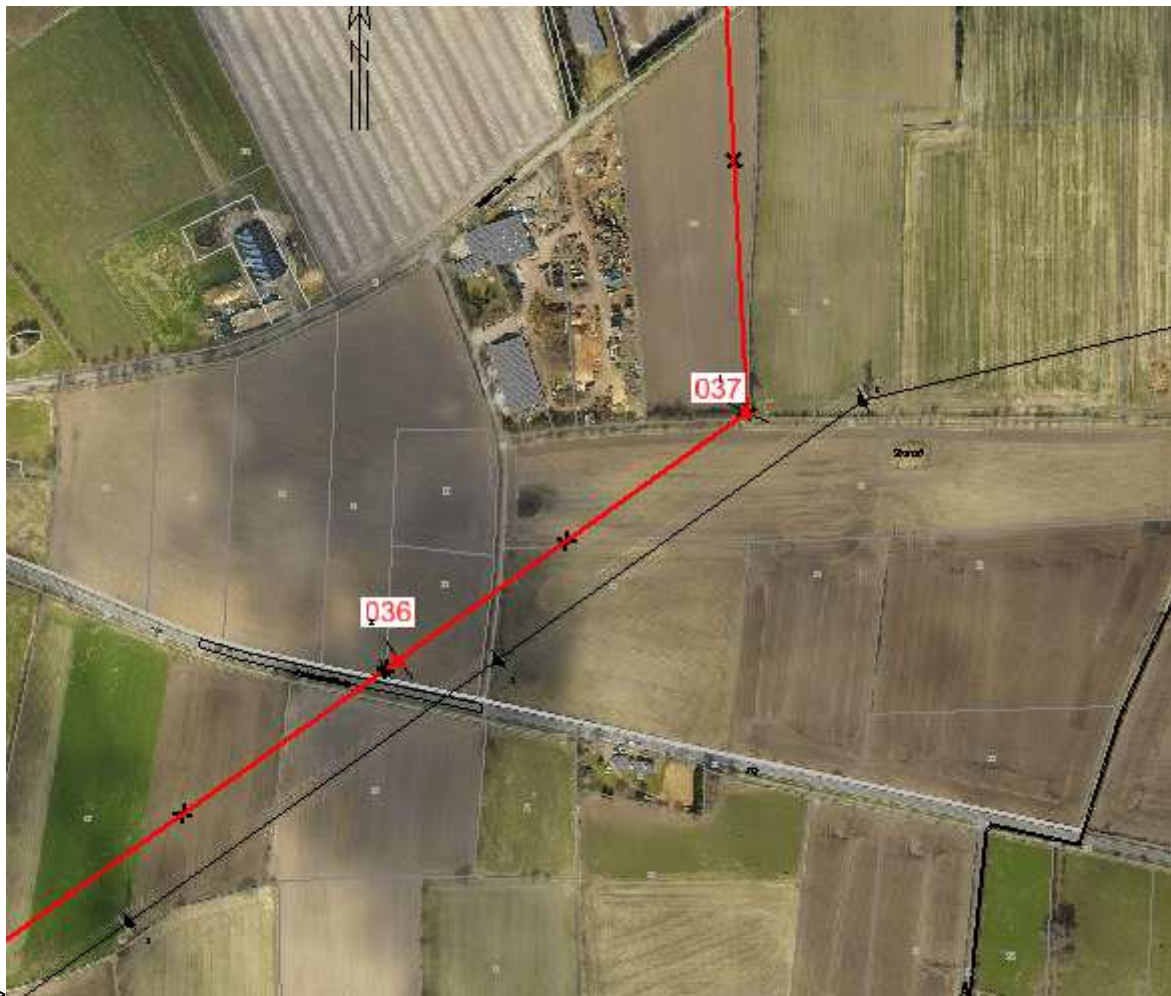
Abbildung 1: Situation am Mast 36; rote Linie = geplante 380-kV-Leitung, schwarze Linie = Bestandsleitung 110-kV
