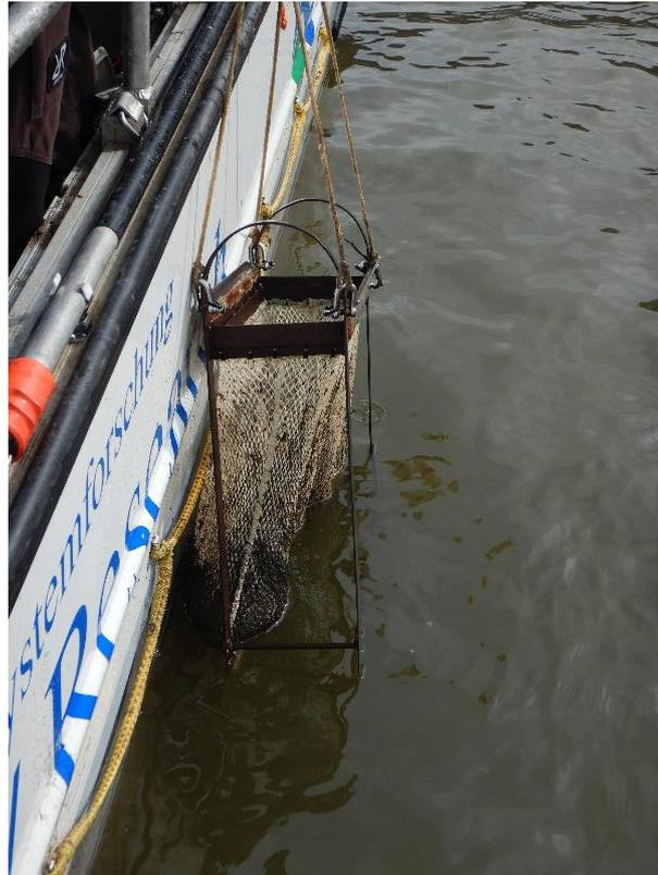
**Abbildung 3:** Handdredge während der Probenahme an Bord des Arbeitsbootes „Aegir“.
