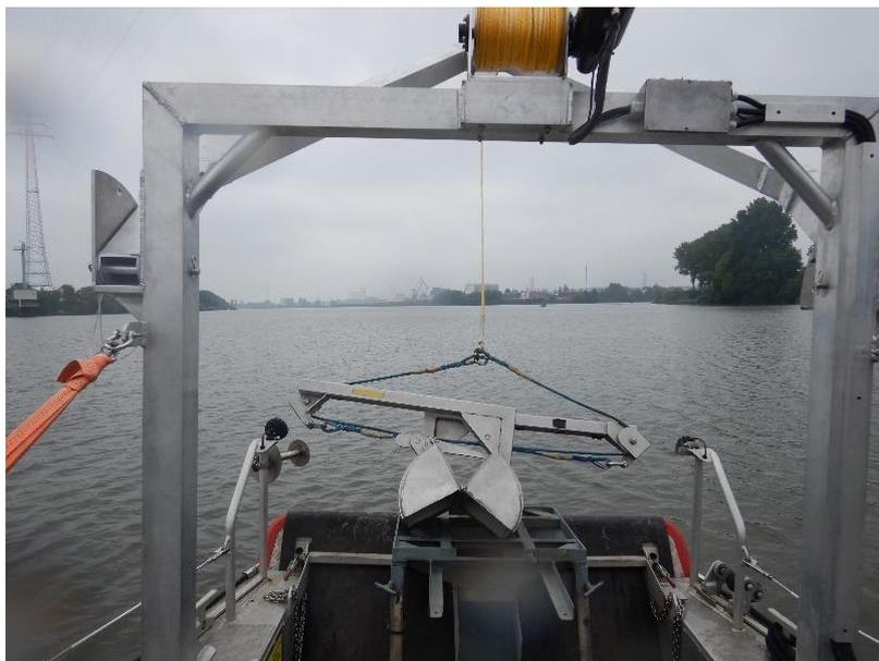
Abbildung 2: van-Veen-Greifer an Bord des Arbeitsbootes „Aegir“.
