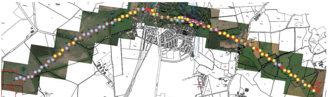
**Abb. 3.6: Bohrpunkte und Bodenarten gemäß Baugrunduntersuchungen entlang der Trasse Henstedt-Ulzburg (Daten vom Ing.-büro BGA, Braunschweig, 2019)**
