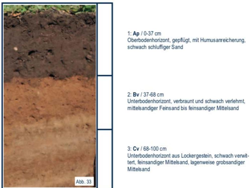
Abb. 3.10: Typisches Braunerde Bodenprofil, nach Burbaum et al., 2019
