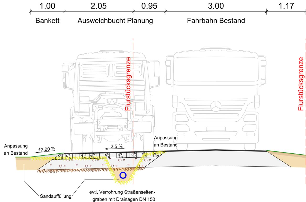
Fahrbahnaufbau Bestand sowie Straßendimensionierung der Ausweichbuchten erfolgt nach Baugrunduntersuchung
