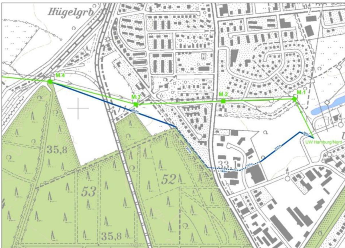
**Abbildung 14: Verlauf des 220-kV-Provisoriums im Bereich Henstedt-Ulzburg (blau) neben der bestehenden 220-kV-Leitung (grün)**
