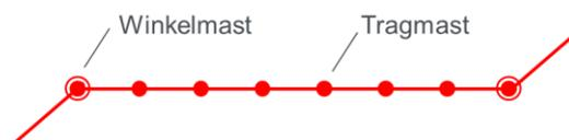
**Abbildung 26: Maximallänge eines Abspannabschnitts bei einem Trag-/Abspannmastverhältnis von 3:1**
