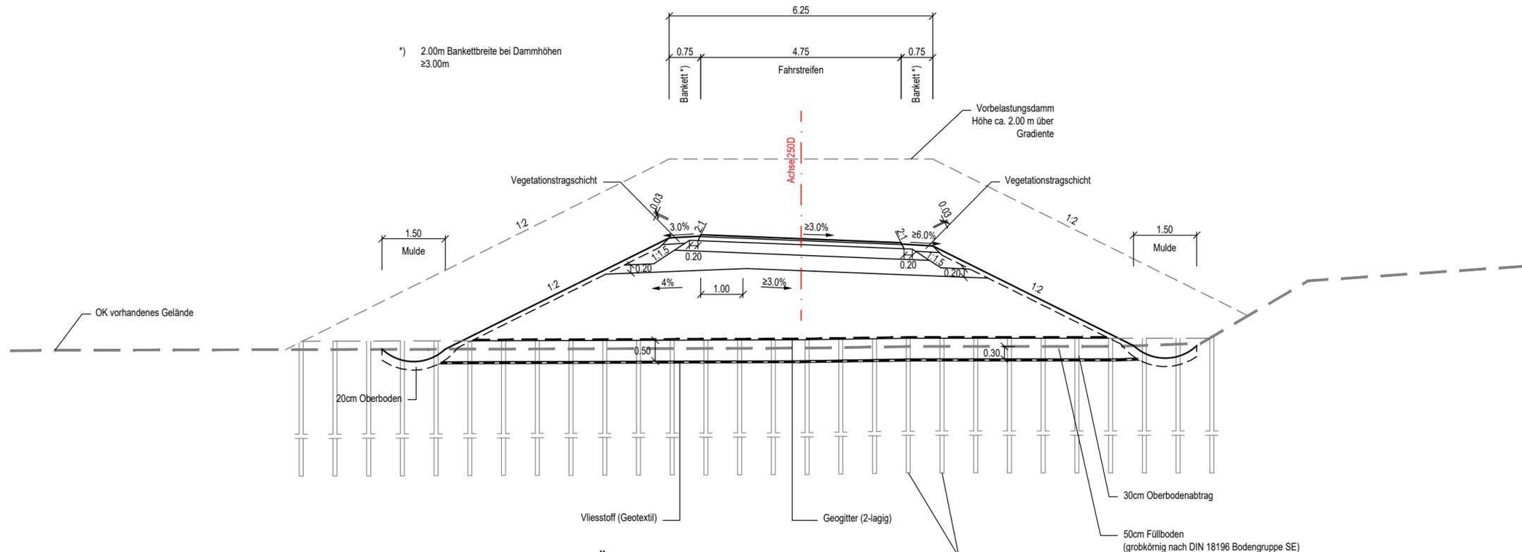
**Aufbau Fahrbahn Überführung Dingsbüldeich der Kat. B**
