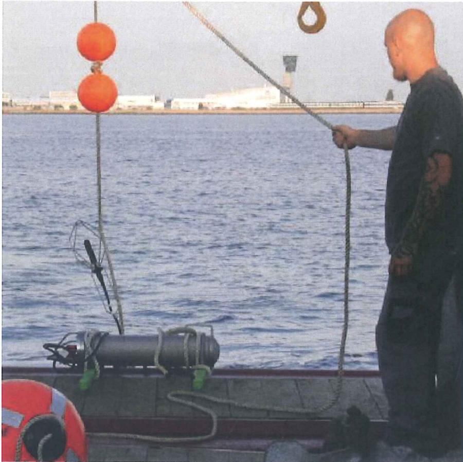
*Abbildung 2 Ausbringung des Aufzeichnungssystems über dem Tunnel. Das Rohrgehäuse war mit Stahlstäben mit einem Querschnitt von 40 x 40 mm<sup>2</sup> und 1 m Länge beschwert (grün lackiert) um den Kontakt des Geophons mit dem Meeresgrund sicherzustellen. Im Hintergrund: Tower und andere Gebäude des Kopenhagener Flughafens und ein Personenzug auf einem Abstellgleis.*
