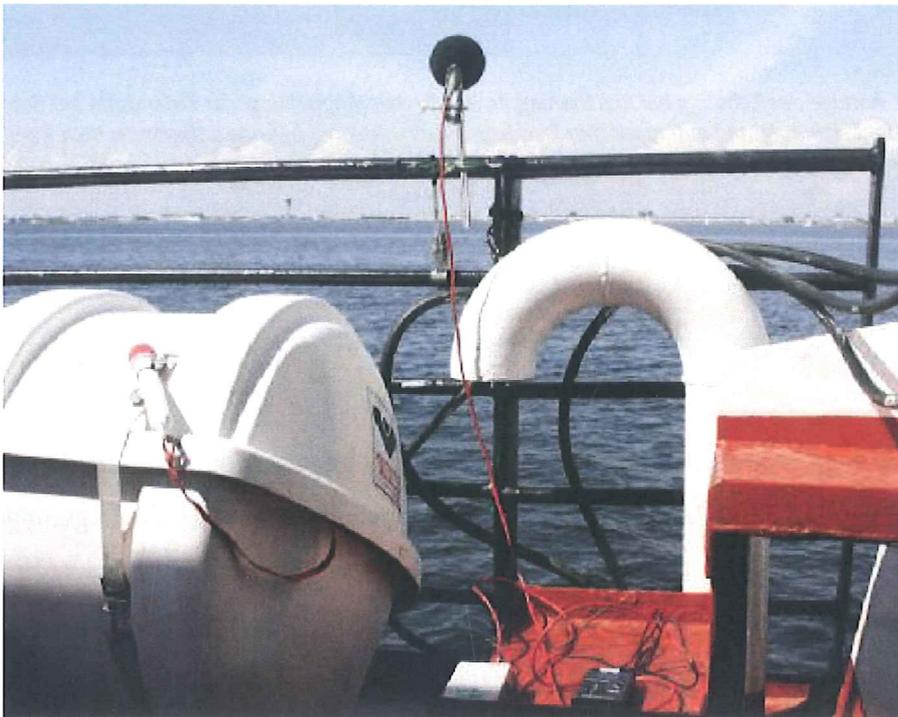
*Abbildung 5. Mikrofon zum Aufnehmen von Fluglärm.*
