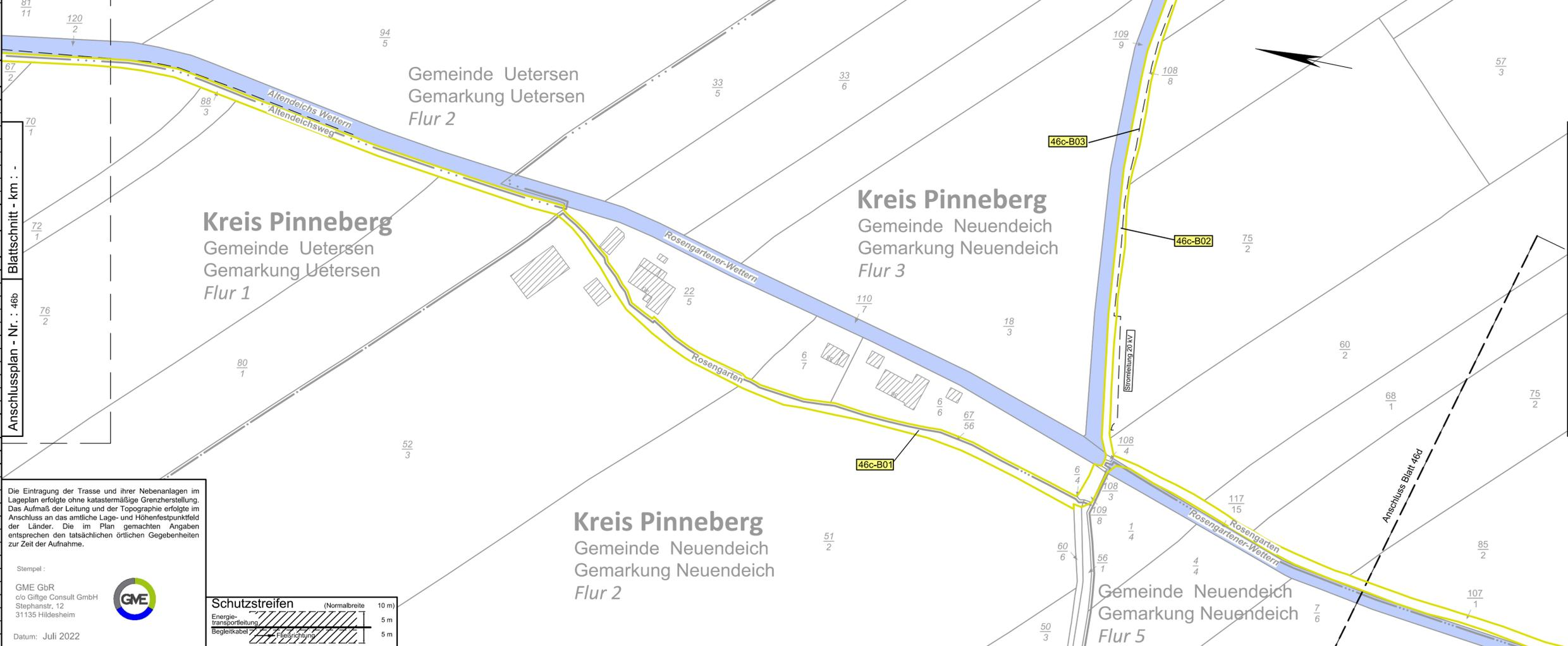
Die Eintragung der Trasse und ihrer Nebenanlagen im Lageplan erfolgte ohne katastermäßige Grenzherstellung. Das Aufmaß der Leitung und der Topographie erfolgte im Anschluss an das amtliche Lage- und Höhenfestpunktfeld der Länder. Die im Plan gemachten Angaben entsprechen den tatsächlichen örtlichen Gegebenheiten zur Zeit der Aufnahme.
