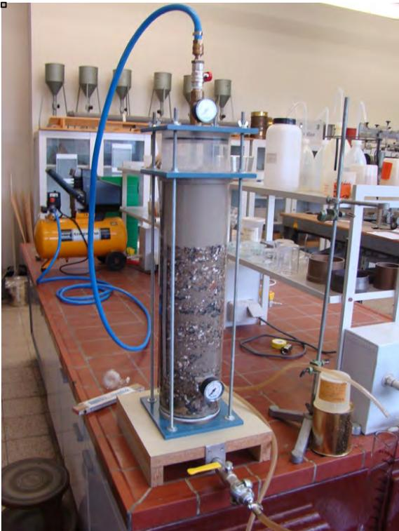
**Abbildung 2: Eindringversuch zur Ortsbruststützung**
