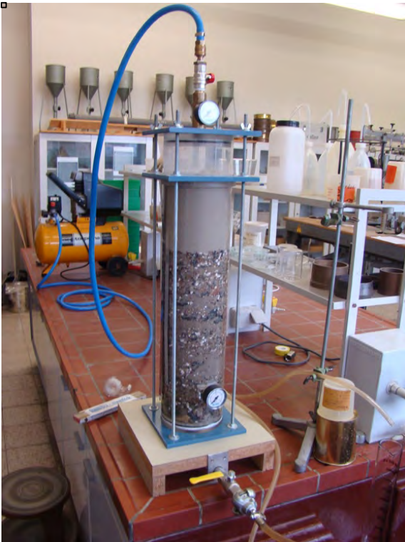
Abbildung 2: Eindringversuch zur Ortsbruststützung
