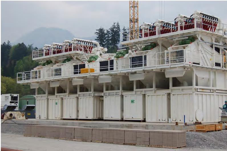
Bild 3: Separationsanlage (Hydrozyklone oben, Siebe im Mitteldeck, Bentonitbecken unten)
