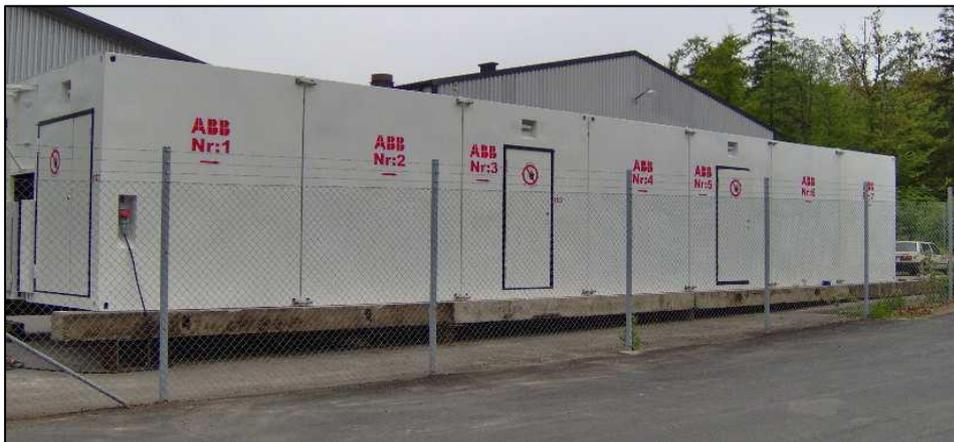
Abbildung 2: Muffencontainer zur Herstellung des Kabelverbindungssystems
