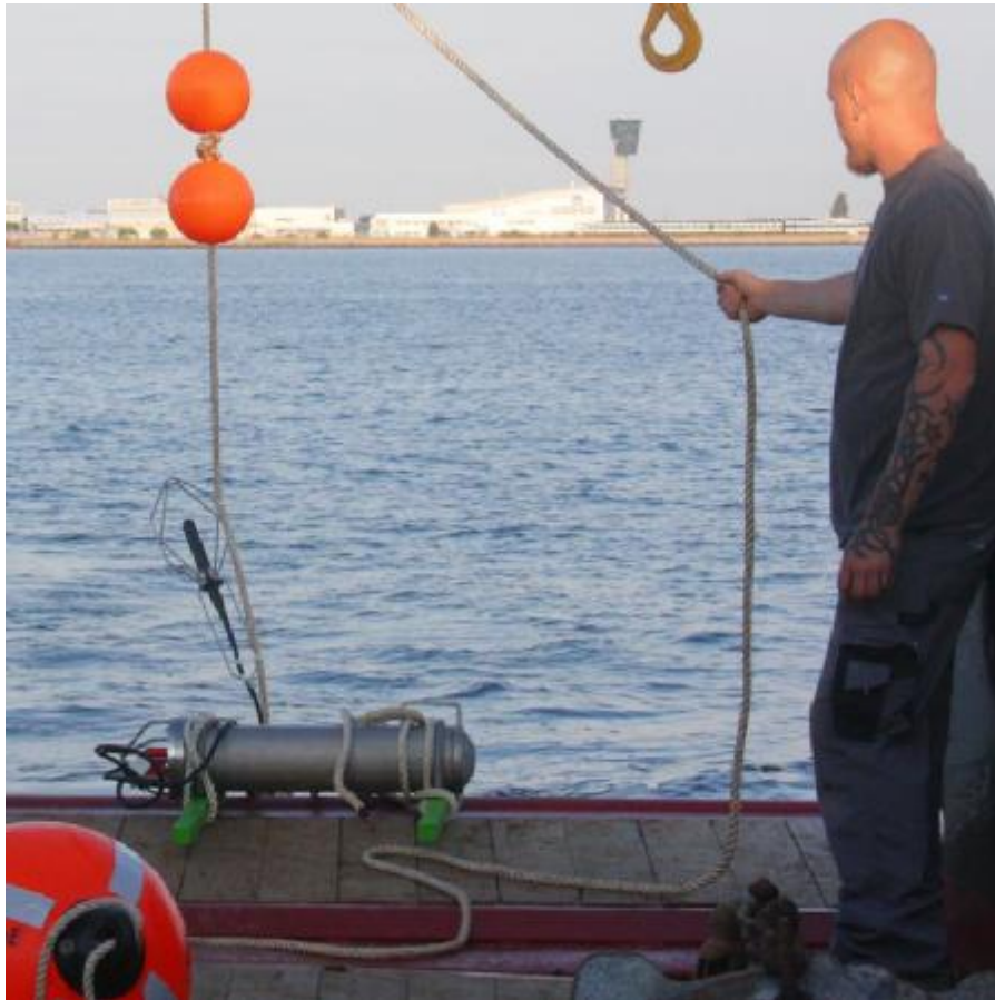
Abbildung 2 Ausbringung des Aufzeichnungssystems über dem Tunnel. Das Rohrgehäuse war mit Stahlstäben mit einem Querschnitt von 40 x 40 mm 2 und 1 m Länge beschwert (grün lackiert) um den Kontakt des Geophons mit dem Meeresgrund sicherzustellen. Im Hintergrund: Tower und andere Gebäude des Kopenhagener Flughafens und ein Personenzug auf einem Abstellgleis.
