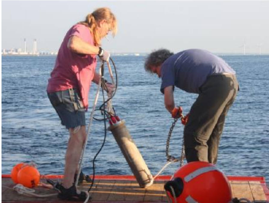
Abbildung 4. Vorbereitung des zweiten Aufnahmegeräts zur Ausbringung 400 m nördlich der Tunneltrasse.
