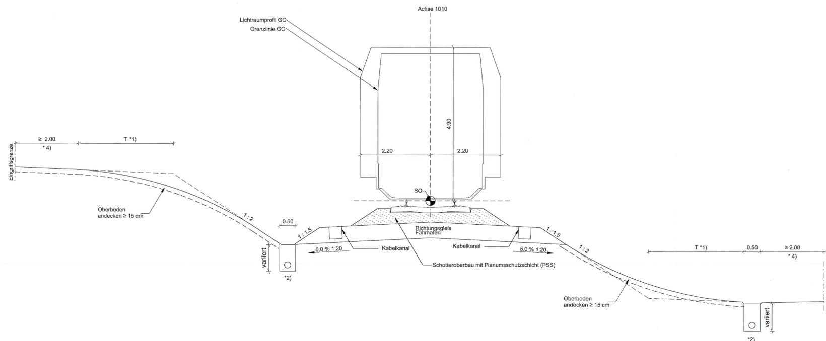
REGELQUERSCHNITT EINGLEISIGE EISENBAHN, 1:50
