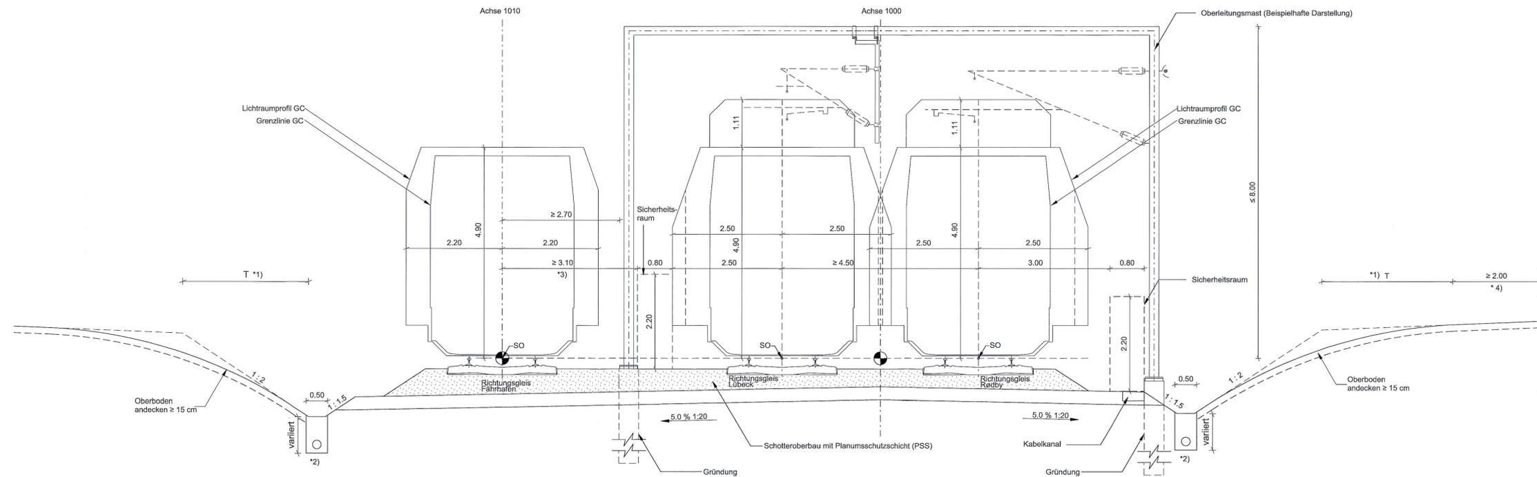
REGELQUERSCHNITT ABZWEIG ANSCHLUSSGLEIS FÄHRHAFEN, 1:50
