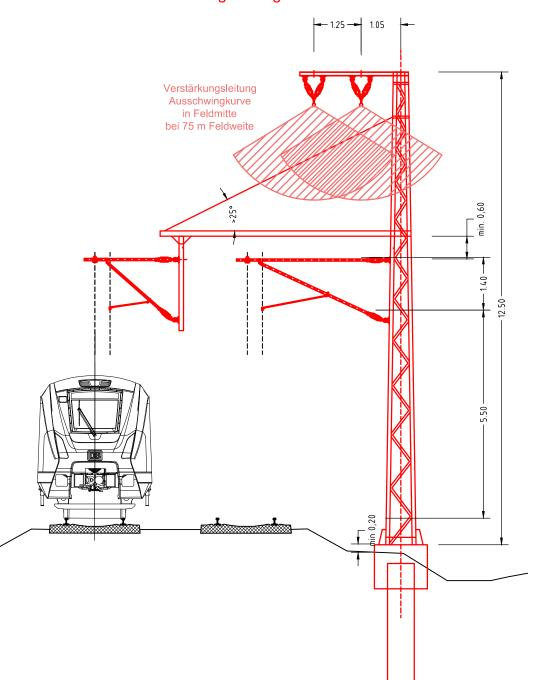
Winkelmast (großer Mastabstand) mit Großrohr-Rammgründung
