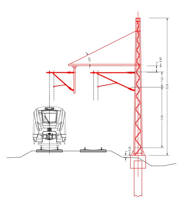
Winkelmast mit Großrohr-Rammgründung
