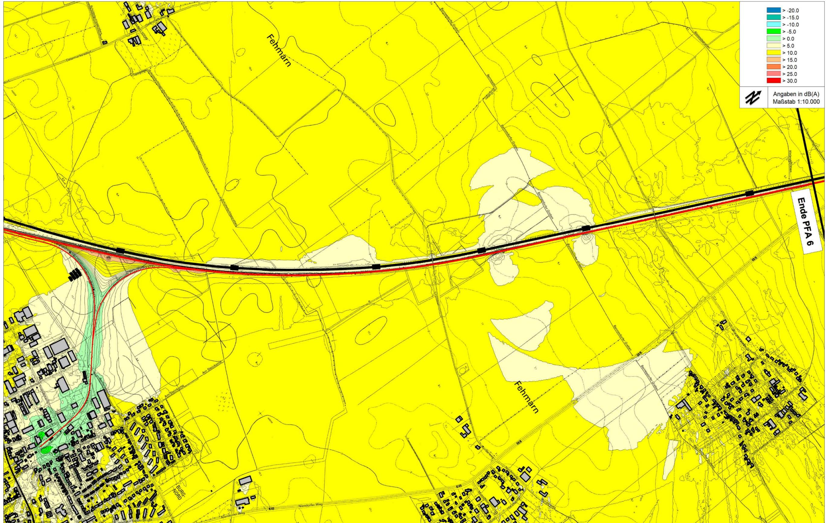
Anlage 3.3.2.1 Beurteilungspegel aus Schienenverkehrslärm nachts (Differenzkarte, Variante V0 zu Prognose-Nullfall), Bereich Süd
