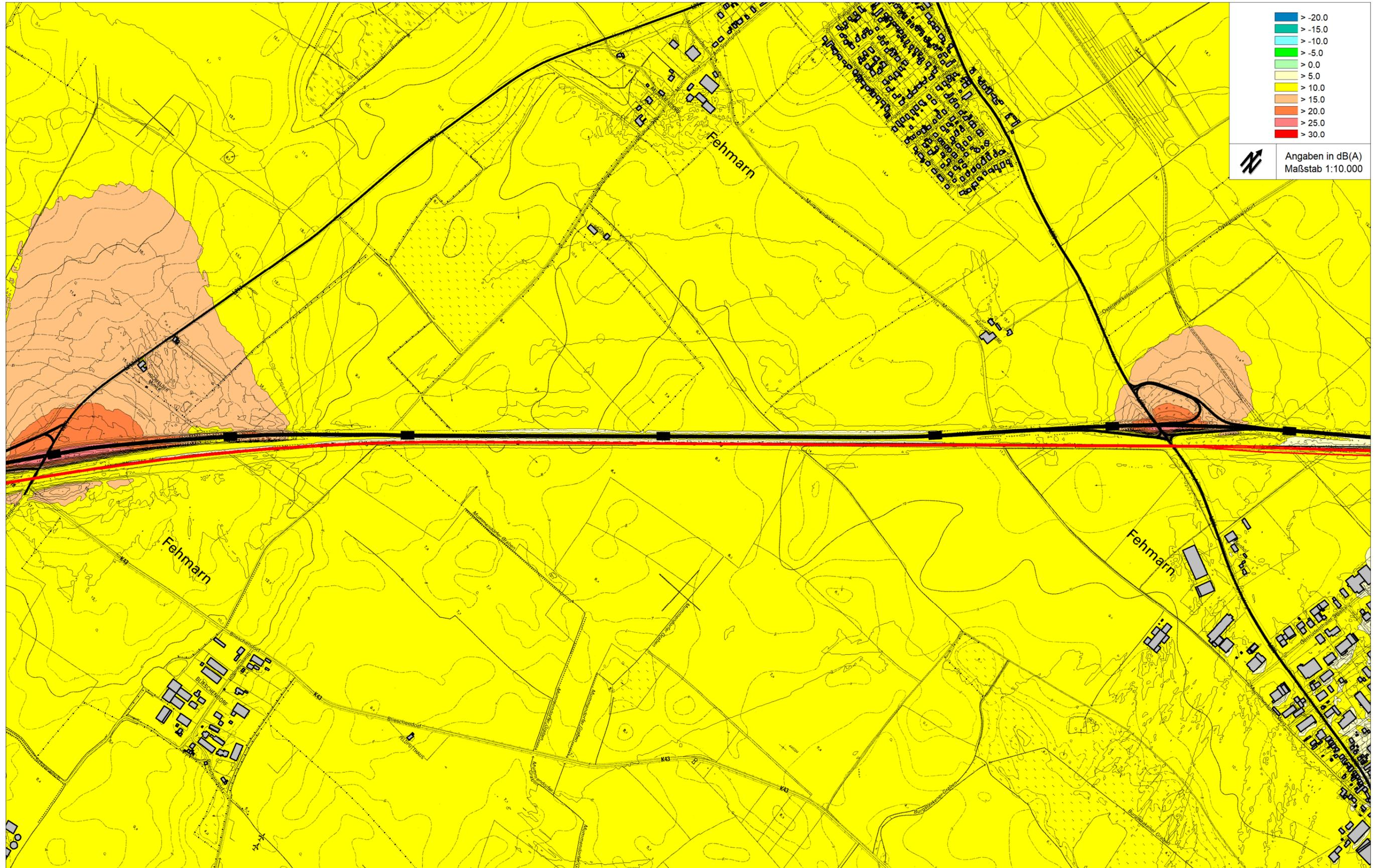
Anlage 3.3.1.3 Beurteilungspegel aus Schienenverkehrslärm tags (Differenzkarte, Variante V0 zu Prognose-Nullfall), Bereich Nord
