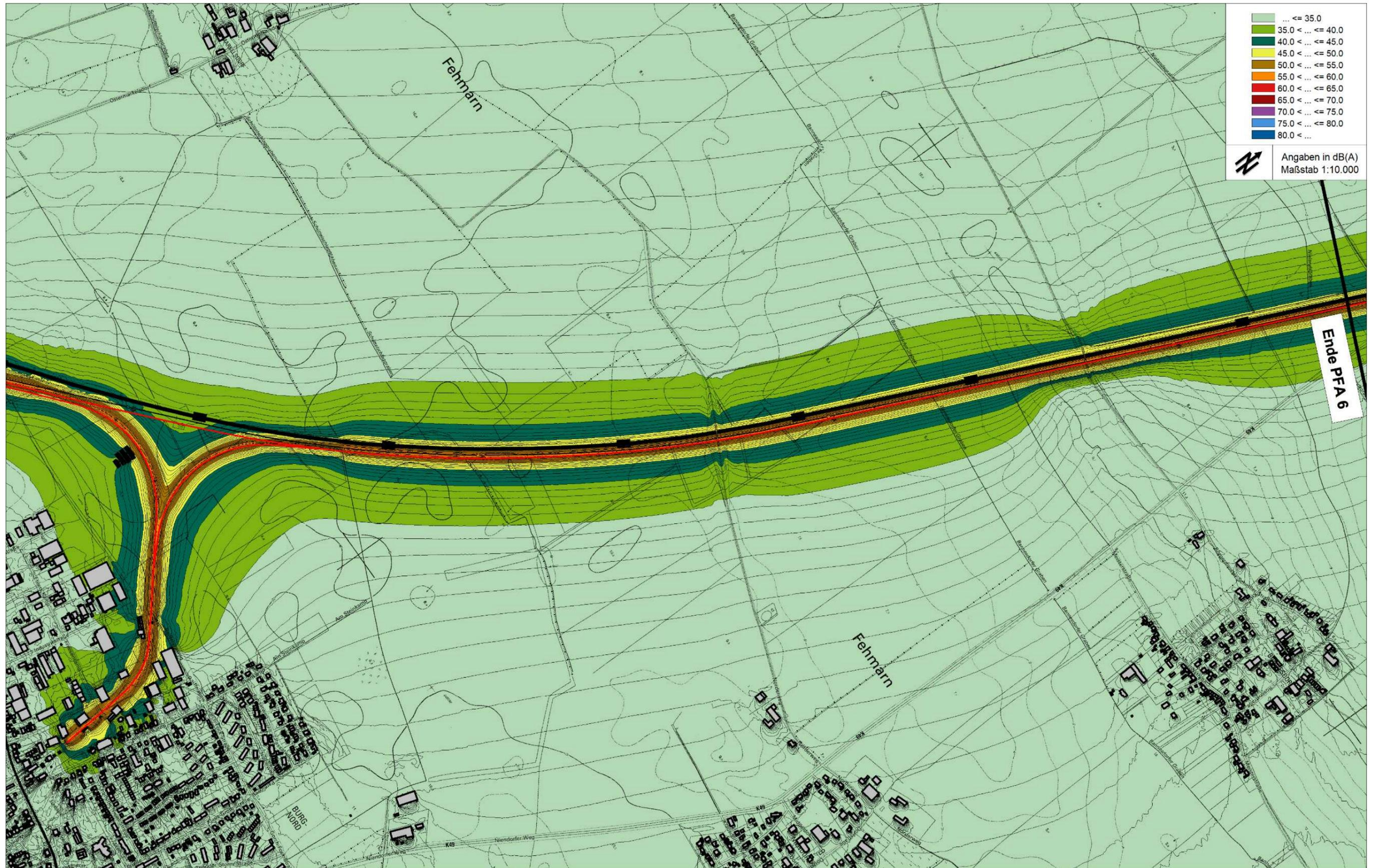
Anlage 3.2.1.1 Beurteilungspegel aus Schienenverkehrslärm tags (Prognose-Planfall, ohne Lärmschutz, Variante V0), Bereich Süd
