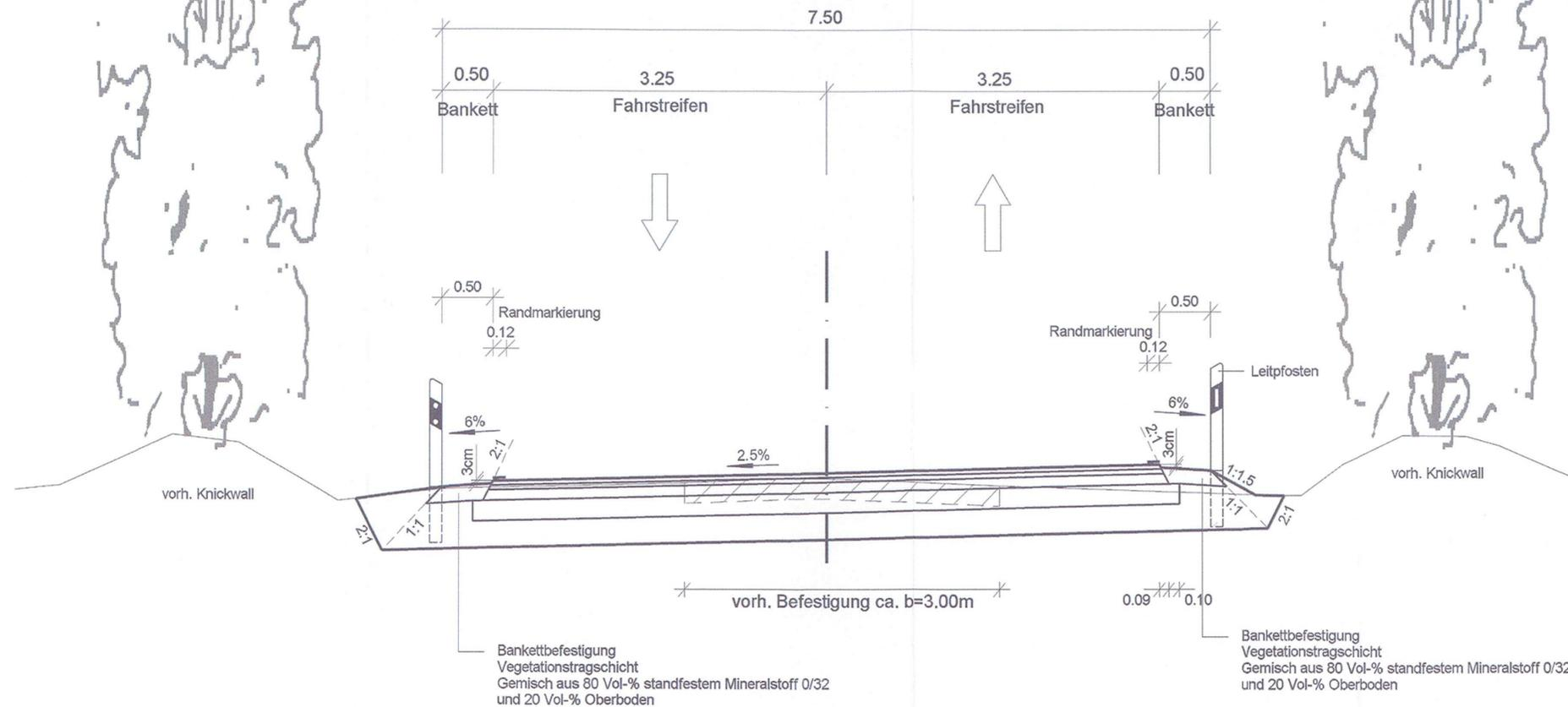
Aufbau gem. RStO 01 in Bauklasse III, Korrekturwert  $D_{Stro} = 0 \text{ dB(A)}$
