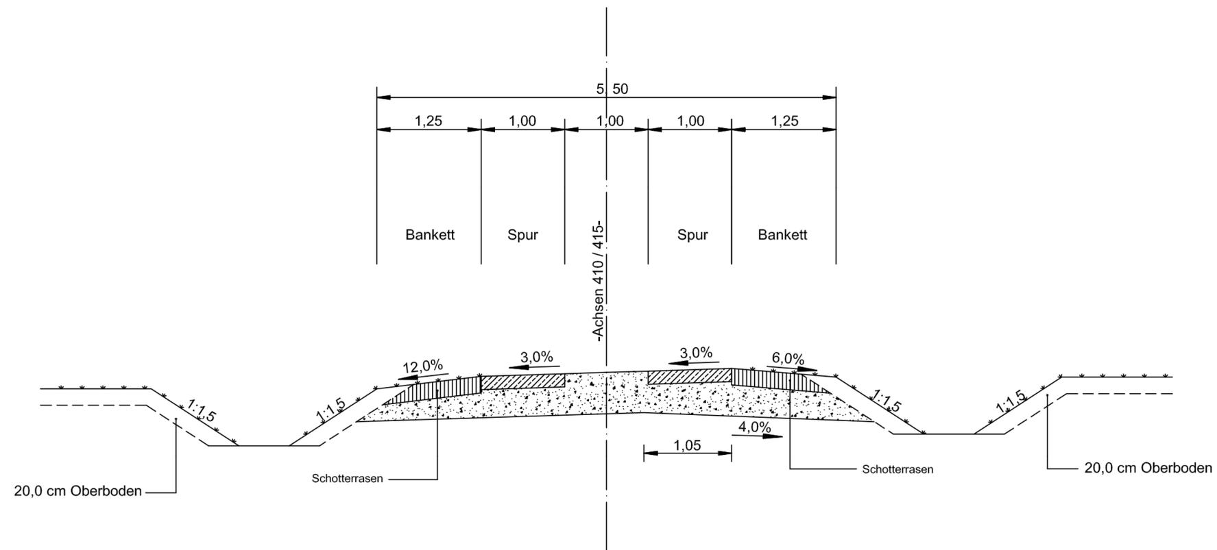
Deckenaufbau Betonspur gem RStO 01 und Ausbauempfehlung vom 21.03.11
