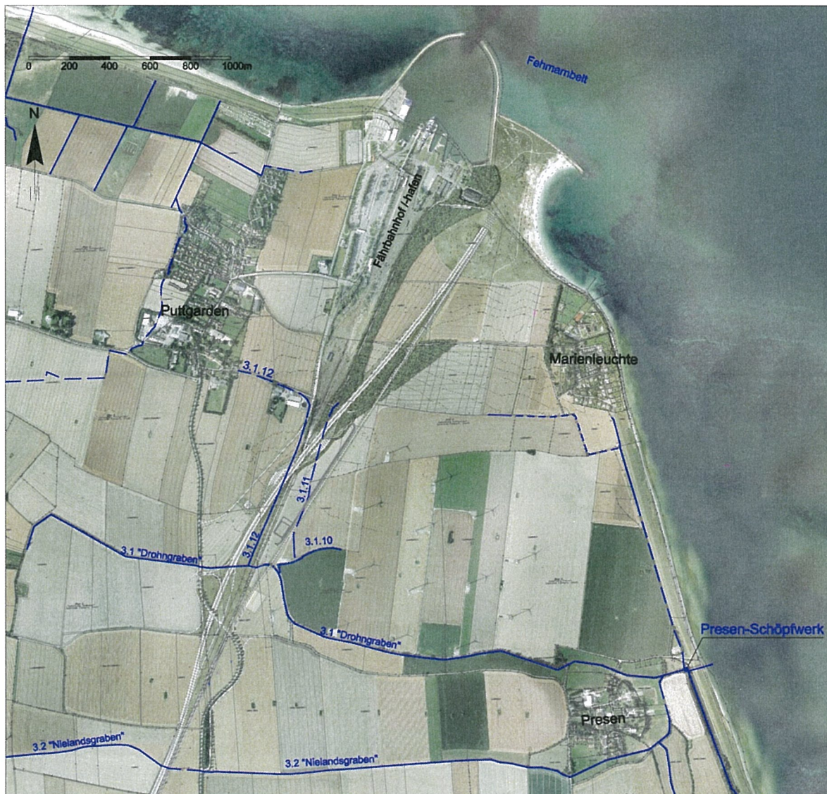
Abb. 1.1: Übersicht vorhandenes Verbandsgrabensystem im Planungsbereich FBQ
