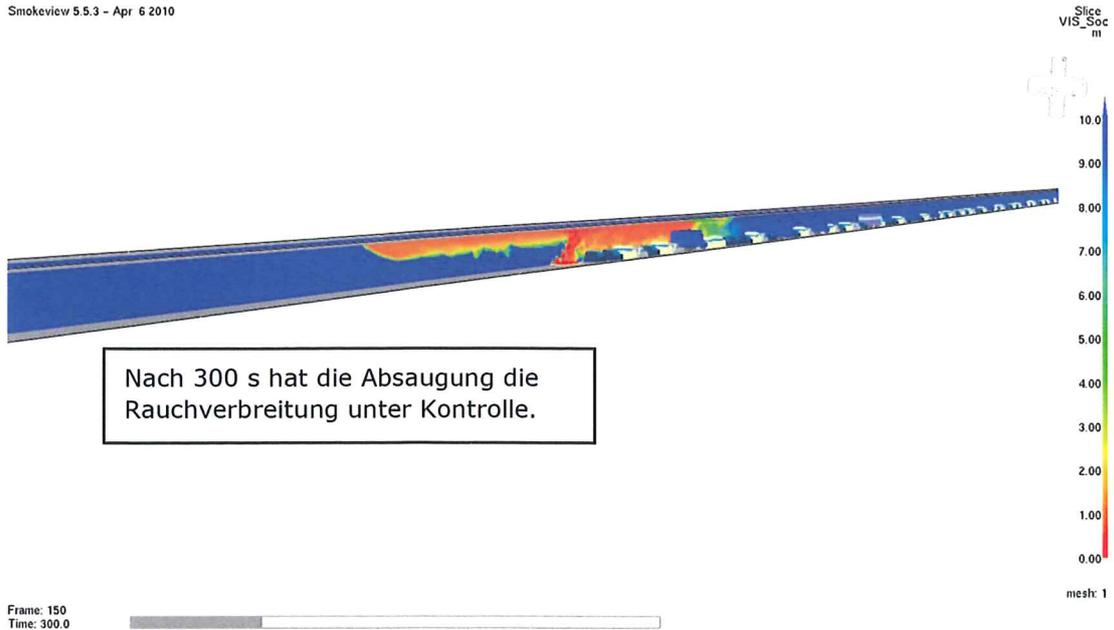
Abbildung 5-7 RABT-Sichtergebnis nach 5 min. Der Rauch ist erst nach 300 s unter Kontrolle.
