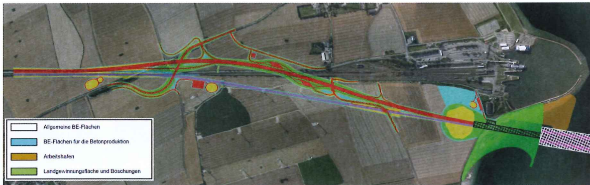
Abbildung 1-6 Beispielhafte Belegung der Baustelleneinrichtungsflächen auf Fehmarn
