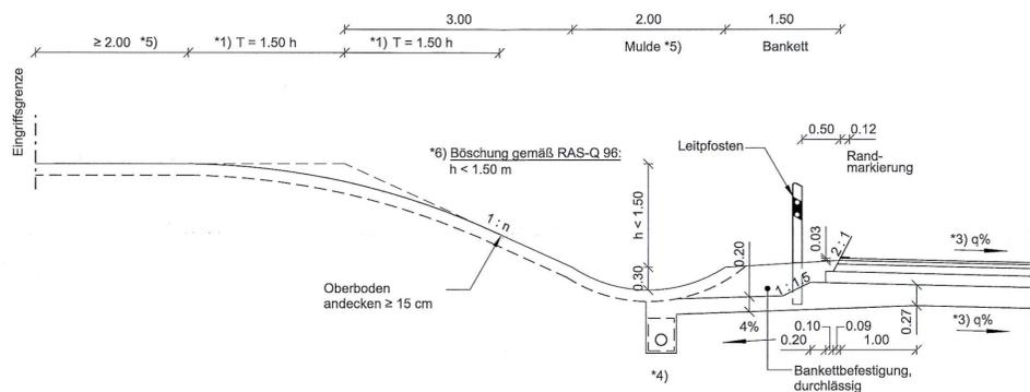
QUERSCHNITT (EINSCHNITT h < 1.50 m), 1:50
