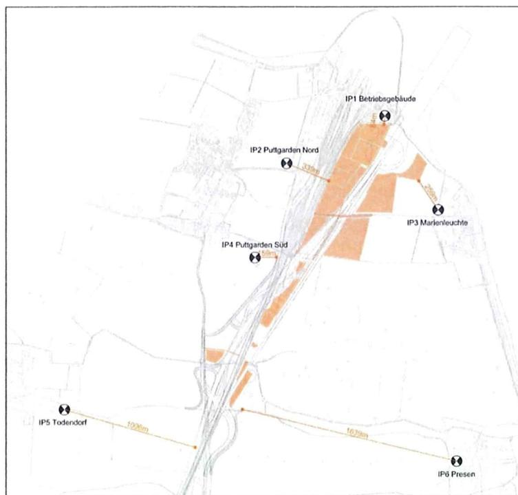
**Abb. 22.3-1 Lage der möglichen Messobjekte zur Erschütterungsüberwachung (IP). Ausgewählte Messorte mit den geringsten Abständen zum erschütterungsintensiven Baubetrieb sind für den Betrieb der Schlagramme IP1 (östliches Betriebsgebäude Fährhafen Puttgarden) sowie IP 3 (Leuchtturm Marienleuchte); für den Betrieb der Rüttelwalze IP1 (östliches Betriebsgebäude Fährhafen Puttgarden), IP3 (Marienleuchte, Rethen1) und IP4 (Puttgarden Süd, Marienleuchter Weg 12).**
