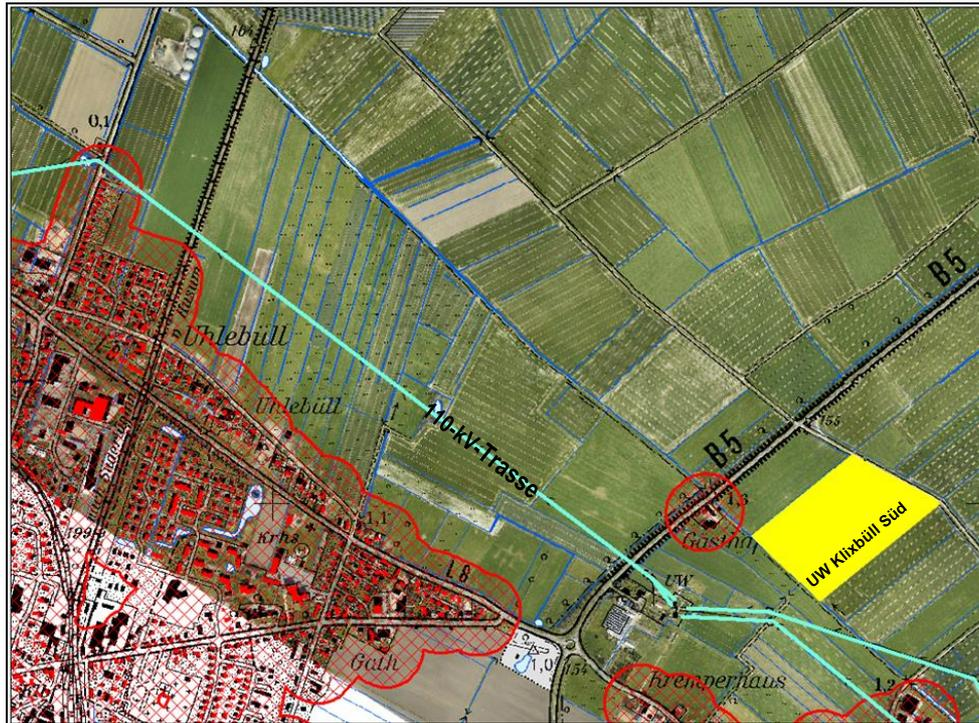
**Abbildung 3: Möglicher Bündelungsbereich mit der 110-kV-Leitung nördlich Niebüll/ Uhlebüll**
