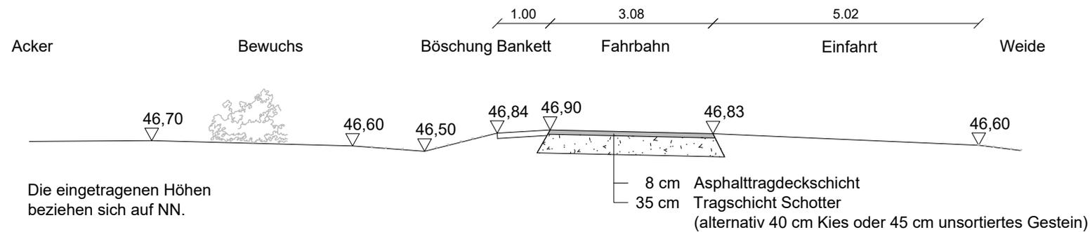
Der dargestellte Straßenaufbau ist in Bezug auf Asphalttragdeckschicht und Tragschicht idealisiert dargestellt und basiert auf Annahmen in Anlehnung an die Vorgaben aus den Richtlinien für den ländlichen Wegebau. Die Mächtigkeit der einzelnen Schichten wird bauzeitlich ermittelt und gemäß dem derzeitigen Aufbau wiederhergestellt.
