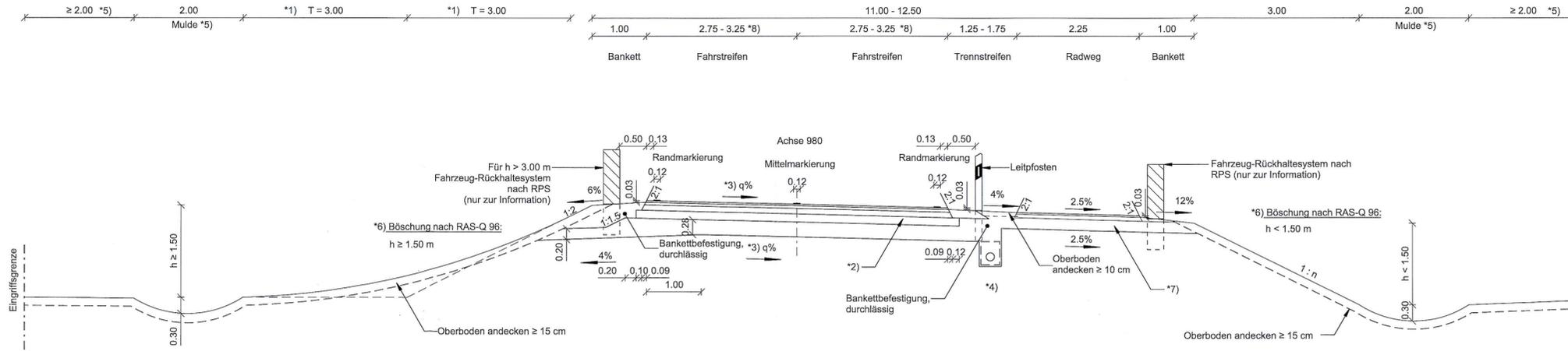
RQ 7.5 REGELQUERSCHNITT (DAMM), 1:50
